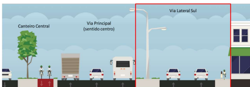
Figura 9: Seção esquemática da Via Lateral Sul
